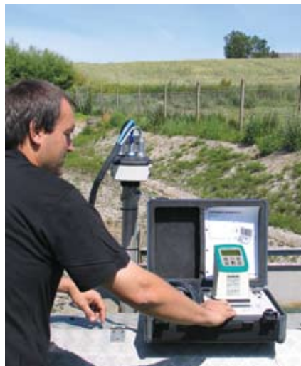
Prüfung des Messaufnehmer-Magnetismus
